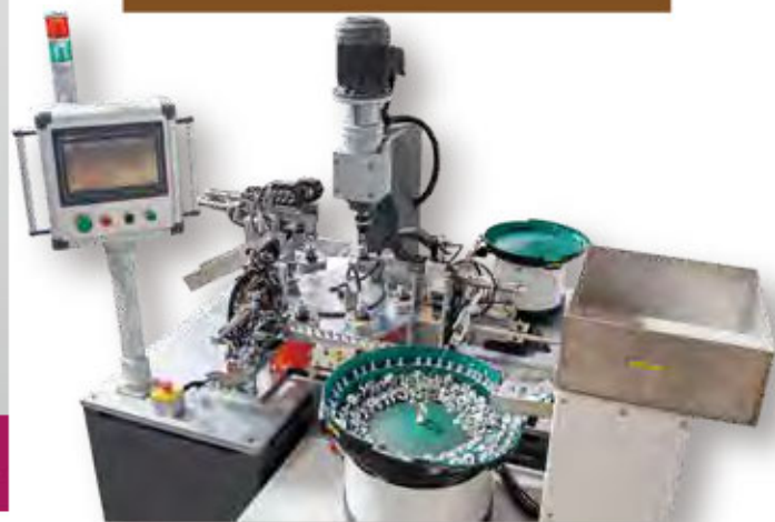
HC-70-SAT 五金件組裝旋鉚機
